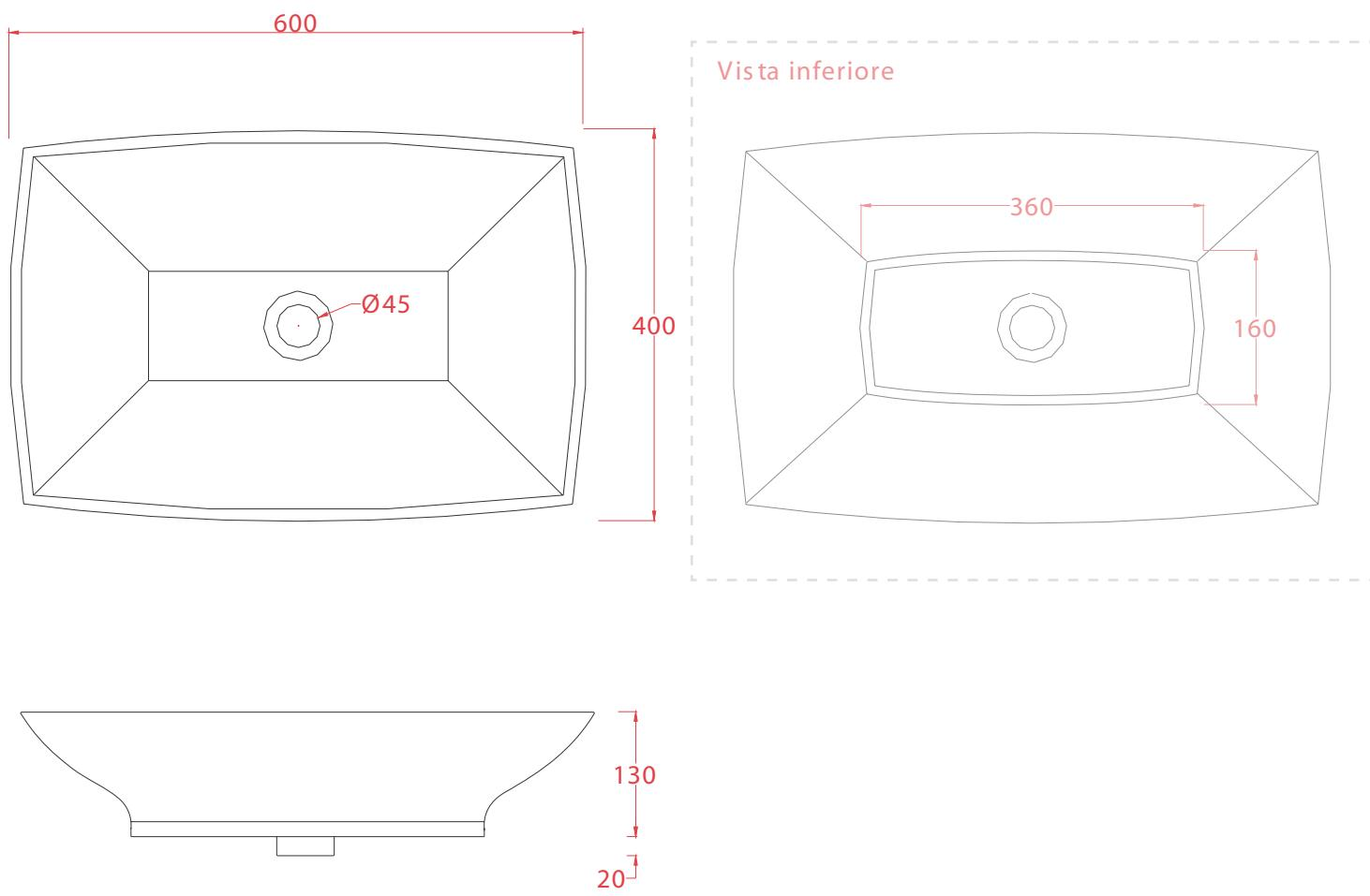
N.B. Le misure indicate possono subire una variazione dell 0,6% circa, dovuta ad usura stampi e a variazioni delle caratteristiche tecniche relative alle materie prime che compongono l'impasto .
